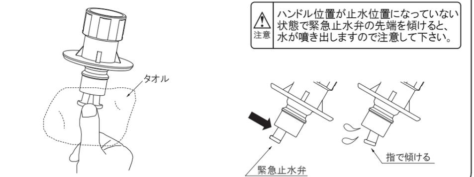
**注意** ハンドル位置が止水位置になっていない状態で緊急止水弁の先端を傾けると、水が噴き出しますので注意して下さい。
