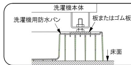
**強制** 洗濯機の脚が左図のような点荷重の場合、洗濯機と洗濯機用防水パンの間に板、またはゴム板を敷いて下さい。
