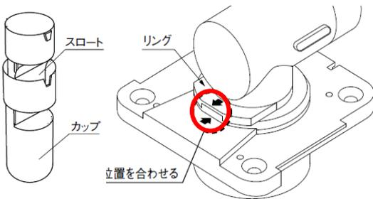
④清掃後は、カップ→スロート→平パッキン→ホースジョイントの順ではずした部品を元に戻します。
