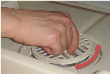
③「封水筒」も同様に矢印の方向に回してはずします。
