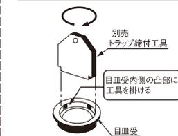
※目皿受の締め付けは、専用工具を使用して確実に行ってください。目皿受は取り付け後、絶対に緩めないでください。トラップ本体が落ちたり、漏水を引き起こすおそれがあります。
